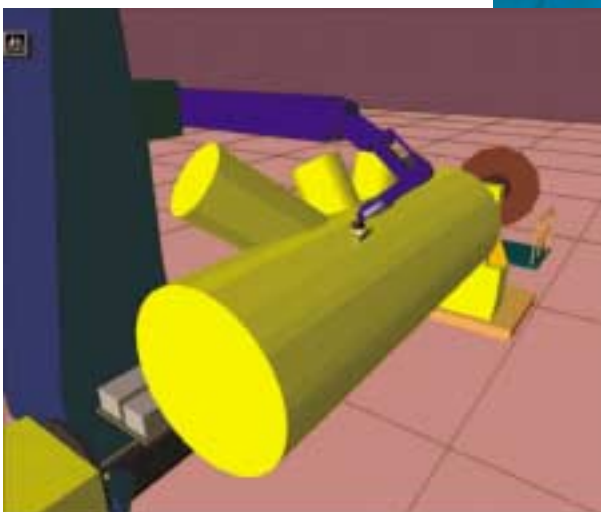
Aker Mäntyluoto Oy on käynnistänyt kehitysprojektin putkiristikkojen solmukohtien robottihitsauksesta.
