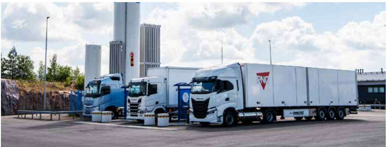
Kuva 5. Nesteytettyä kaasua käyttävä raskas ajoneuvo kulkee ajoneuvomallista riippuen jopa 1 600 kilometriä sekä paineistettua kaasua käyttävä ajoneuvo noin 600 kilometrin matkan yhdellä tankkauksella. Kuva: Gasum.
