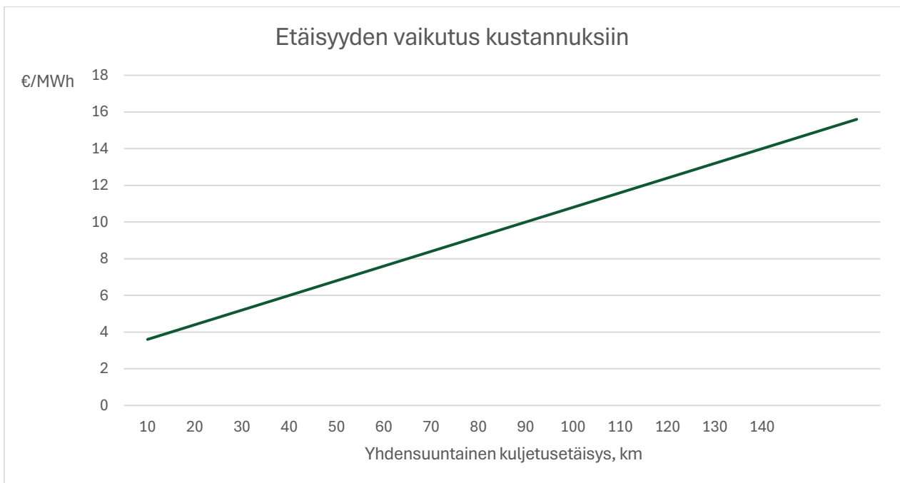
Kuva 10. Konsulttiyhtiö Maconin arvio kuljetusetäisyyden vaikutuksesta jalostetun ja paineistetun biometaanin konttikuljetuksen kustannukseen.
