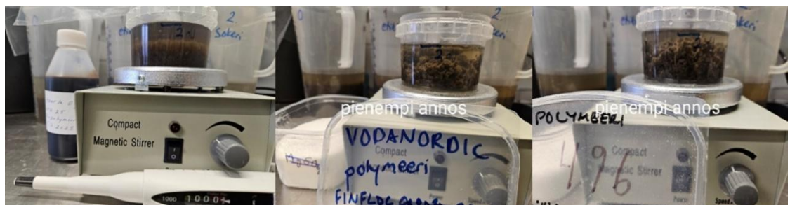
Kuva 15. Sakeamman palautuslietteen flokkaaminen Haaran tanniini-biopolymeerillä, ja perinteisillä Votanordicin FINFLOC:illa ja Kemiran Superfloc C496HMW:lla.
