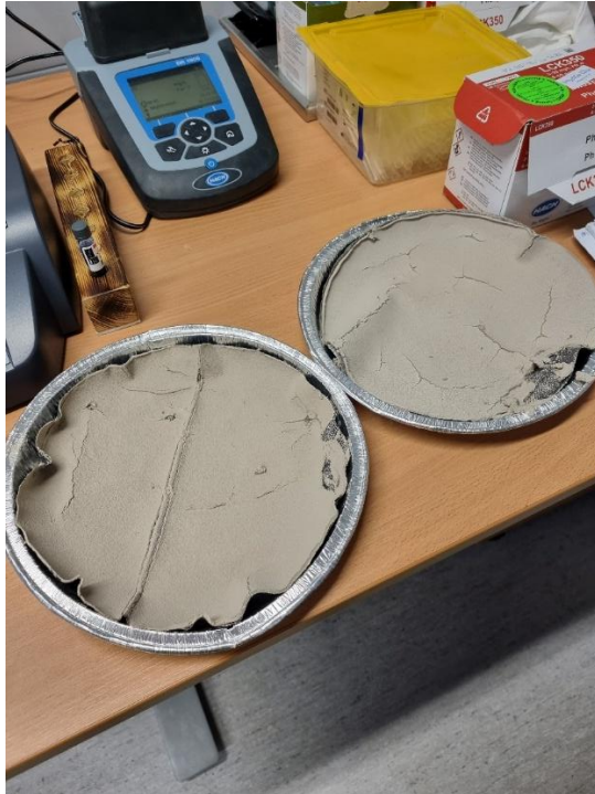
Kuva 6. Suodatettu ja uunissa (40°C) kuivattu sakka.
