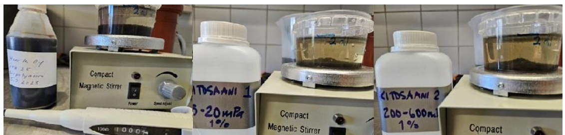
Kuva 13. Haarlan tanniinilla, pienempi- ja suurempiviskositeettisella kitosaanilla saostetut palautuslietteet.
