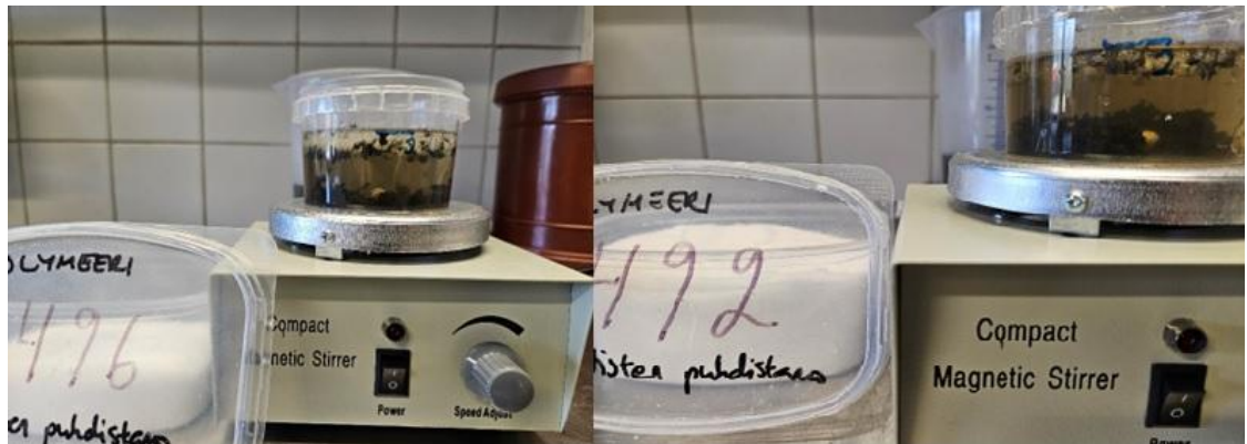
Kuva 14. Huittisten Puhdistamon laihemman palautuslietteet laskeuttamisen jälkeen. Polymeereinä puhdistamon prosessissa käytössä olevat Kemiran polymeerit Superfloc C496HMW ja Superfloc C492HMW.
