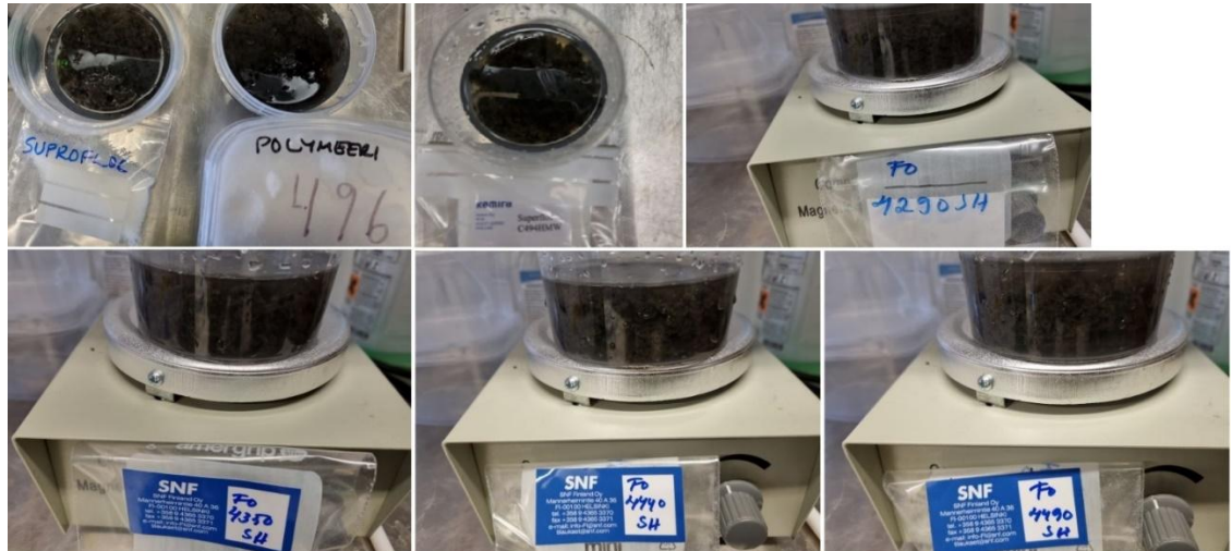
Kuva 12. Parhaiten toimineet polymeerit Suproflow, Superflow C496HMW, Superflow C494HMW, FO 4290 SH, FO 4350 SH, FO 4440 SH ja FO 4490 SH laskeutuksen jälkeen sakeassa palautuslietteessä.
