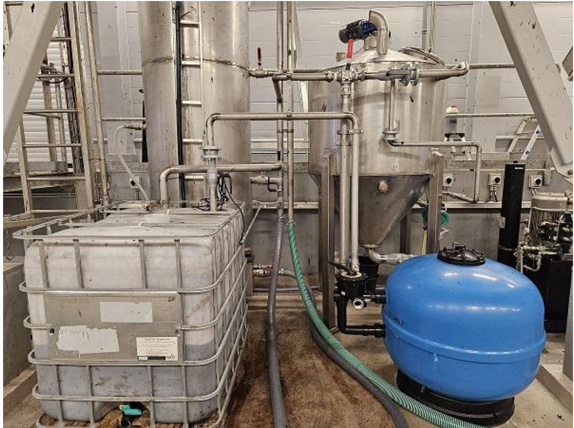
Kuva 7. Struviitin kiteytyksen pilot-laitteisto. Vasemmalla takana lietteen vanhennussäiliö, vasemmalla edessä IBC-kontti lietteen laskeutukseen, oikealla edessä hiekkasuodatin ja oikealla takana kiteytin.
