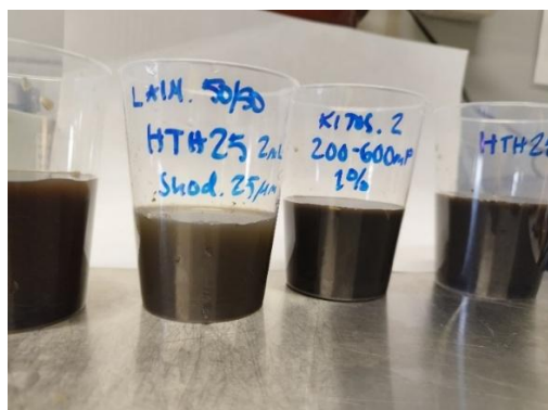
Kuva 6. Näytteet laimennetusta ja suodatetusta Haarlan biopolymeerillä sekä kitosaanilla testatusta Biolinjan rejektistä.
