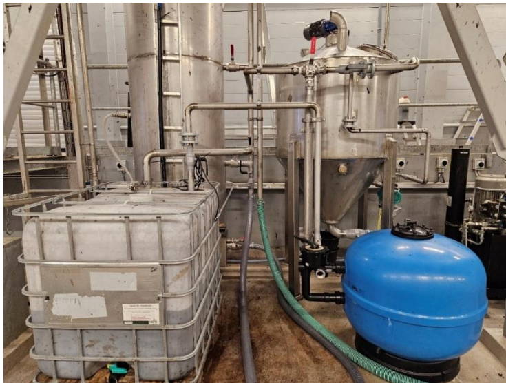
Kuva 4. Struviittikiteytyksen pilot-laitteisto Huittisten Puhdistamolla.
