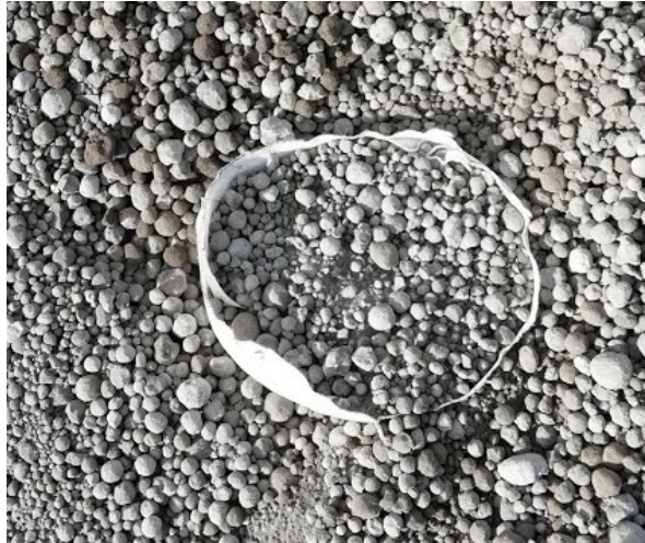
Näyte rakenteen tasossa odottamassa jyräystä.
