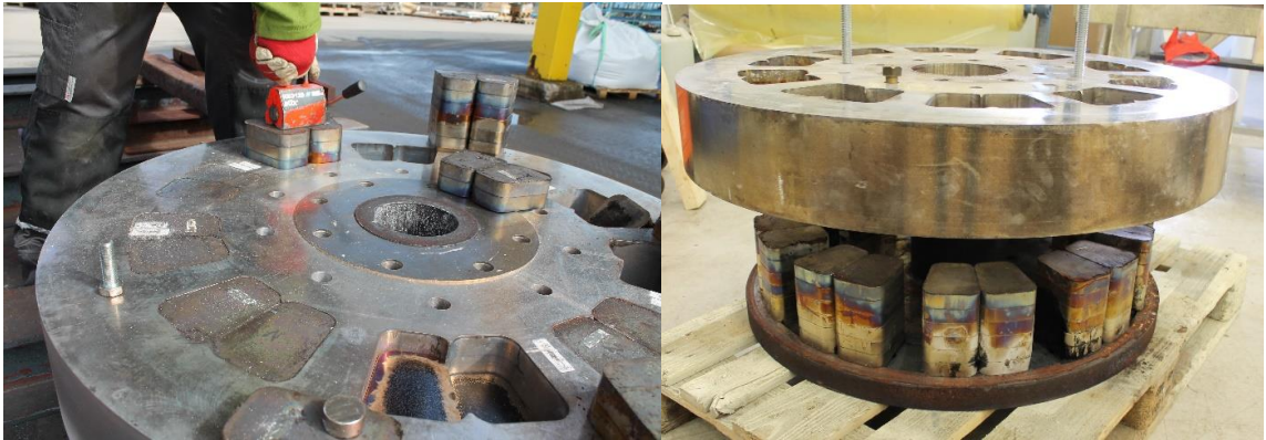
Kuva 14. Magneettien irrottaminen roottorien alumiinikiekoista: magneettinostimen avulla (vas.) ja nostamalla hallinosturilla alumiinikiekko pois magneettien ympäriltä.
