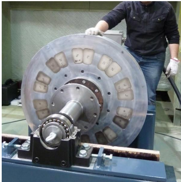
Kuva 12. Romumagneettien lähteenä toiminut magneettikuumentimen roottori.
