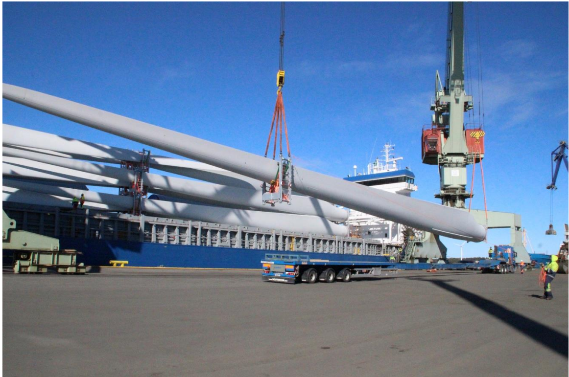
Kuva 2.6.2-1: Turbiinin lapoja puretaan laivasta Mäntyluodon satamassa (Hacklin Oy)
