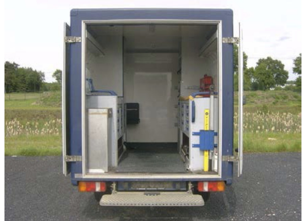
17 vas. VW T5/T6 muunnettuna tuulivoiman huoltoajoneuvoksi. Hinta ilman invertteriä/muuntajaa n. 7.800€ ja oikea kuorma-auton pohjalle rakennettu huoltoajoneuvo [ www.fahrzeugbau-duelmer.de ]
