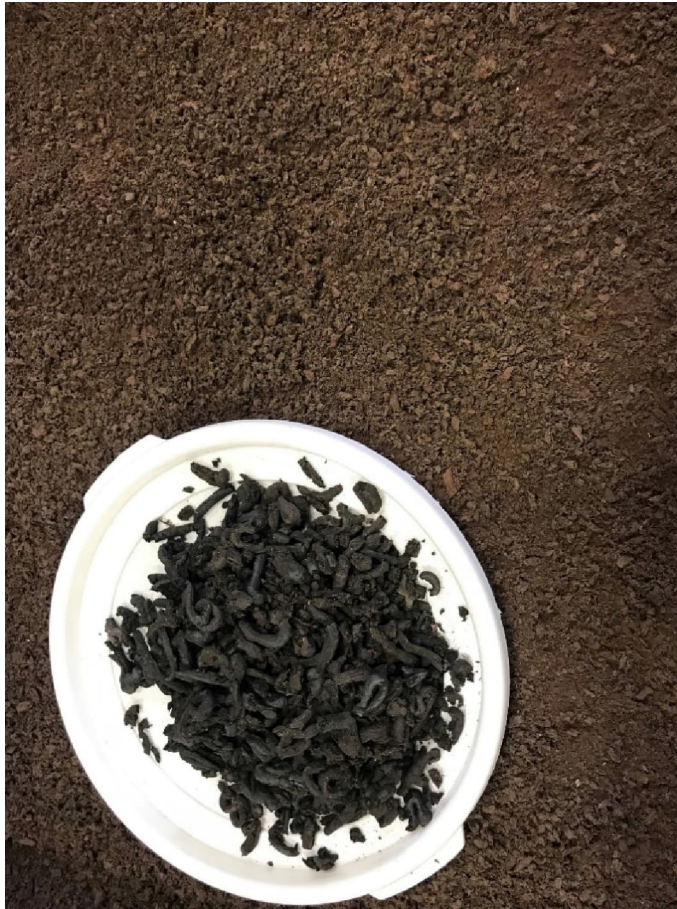
Kuva9. ENVOR-mädätysjäännös kuivattuna (alareuna) ja kuivattuna ja jauhattuna.
