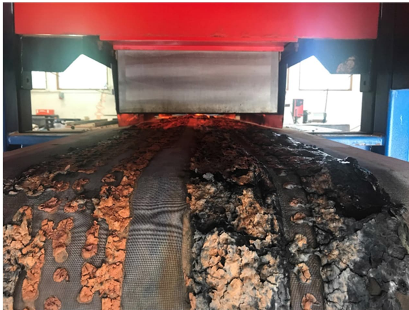
Kuva 10. Infrapunakuivauksessa palanutta konsentraattia.
