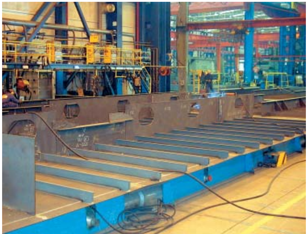
Tasolohkojen valmistusta Aker Finnyards Oy:n Rauman telakalla.
