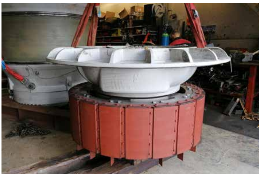
Generaattorista ulos nostettu, ruskeaksi maalattu roottori sisältää 250 kg harvinaisia maametalleja sisältäviä magneetteja.
