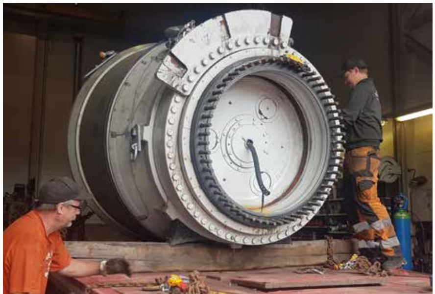
Tuulivoimalan voimalinja eli generaattori ja vaihteisto painoi yli 20 tonnia, joten ihan millään pienellä nosturilla sitä ei liikuteltu.
