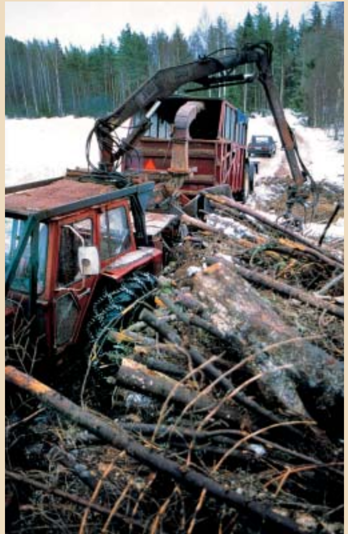
Energiapuuta haketetaan kasasta perävaunuun. Lämpöyrittäjä kuljettaa hakkeen hoitamalleen hakelämpökeskukselle. Kuvaaja Anne Kärkkäinen.
