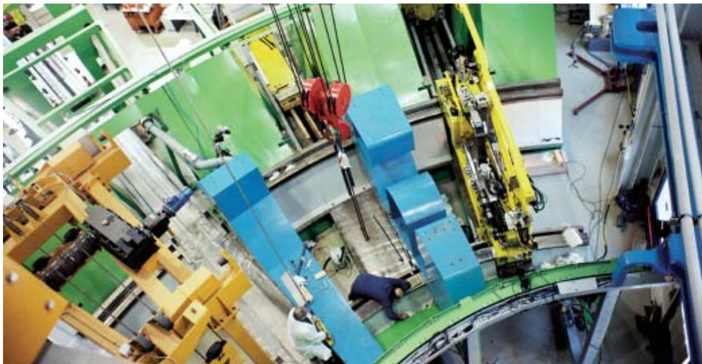
Reaktorin diverttori, jonne mm. IHA on simuloitunut huoltojärjestelmiä.
