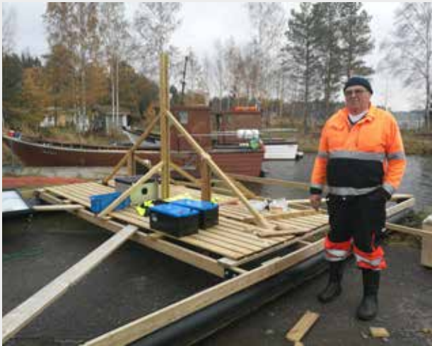
Kalastaja Heikki Salokangas ja mittauksia varten rakennettu lautta. Lautalle tulivat lisäksi aurinkopaneelit ja akut mittauslaitteiden vaatimaa sähköä varten.
