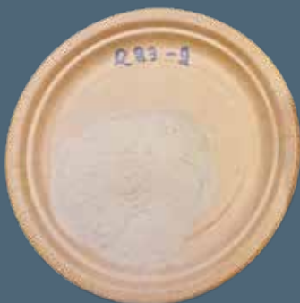
Kuvassa jätevedestä kiteytetty struviitinäyte, joka analysoitiin XRF-menetelmällä Tampereen yliopistolla. (Kuva Jari Turunen, TUNI).
