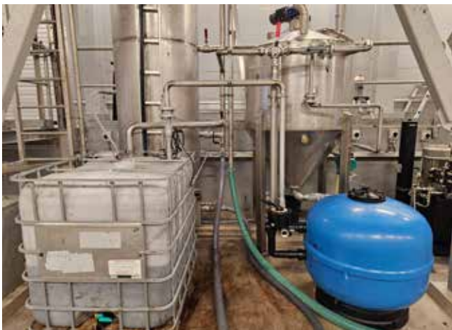
Struviitin kiteytyslaitteisto: vasemmalla takana vanhennussäiliö, vasemmalla edessä IBC-kontti, oikealla edessä hiekkasuodatin ja oikealla takana kiteytin.
