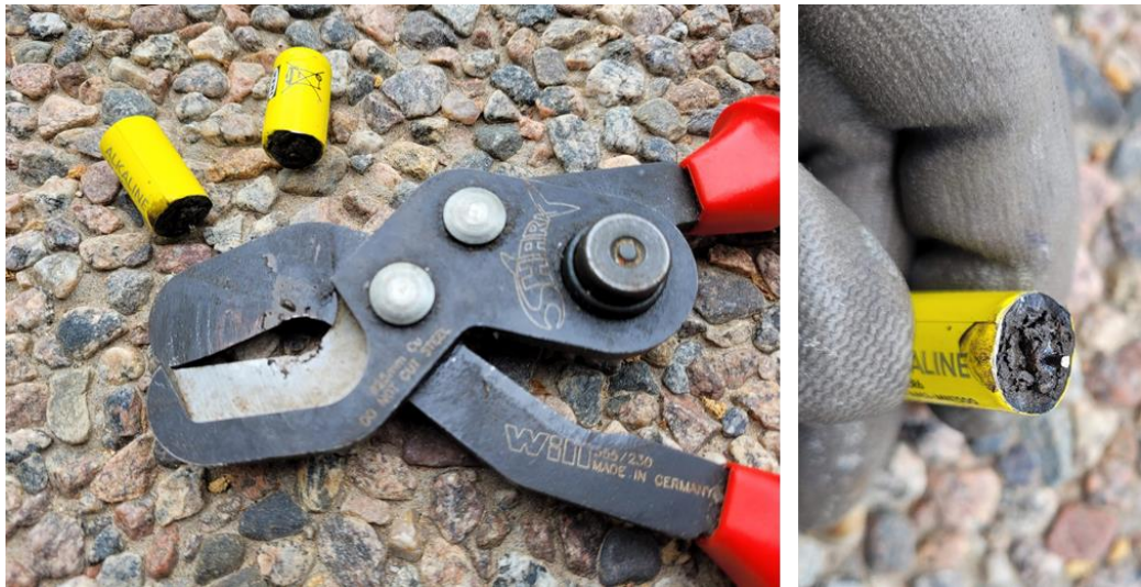
Kuva 7.7: Kennojen katkaisu kaapelileikkurilla
