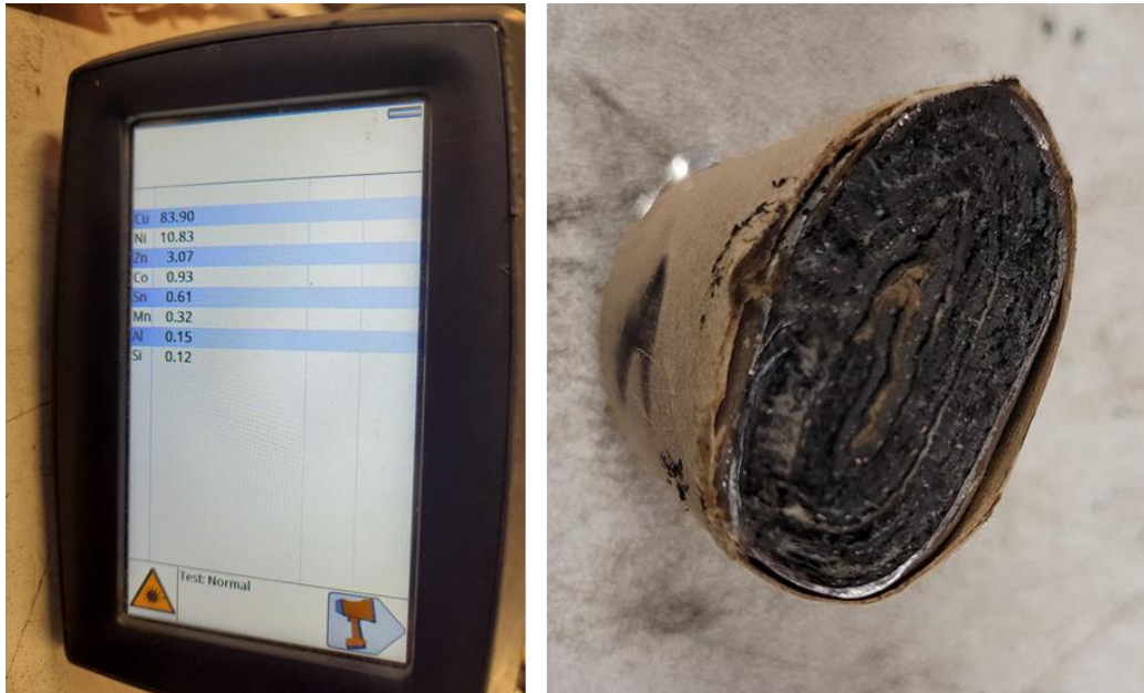
Kuva 7.11: NiMH mittaus (vrt. mittaus #17 taulukossa 7.1)
