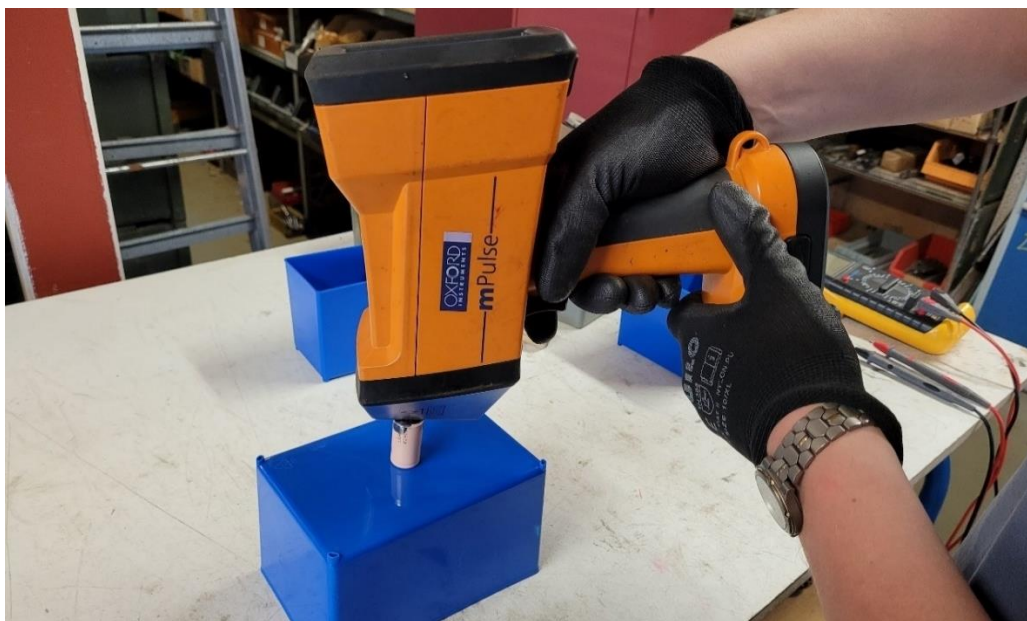
Kuva 7.10: Litium kennon tutkiminen Oxford Instruments mPulse –analysaattorilla
