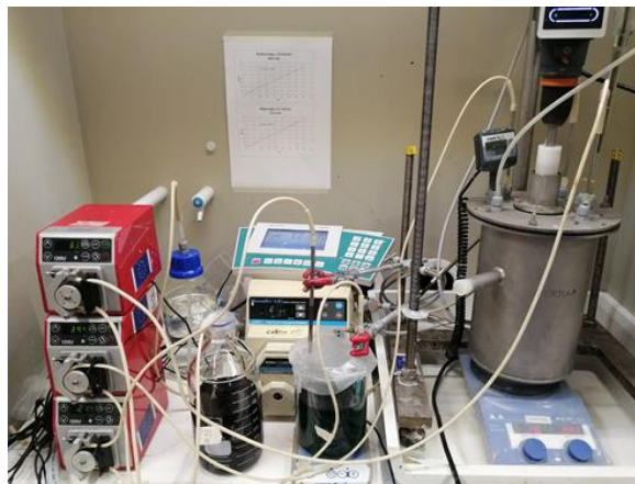
Kuva 5. Kersaostus on tyypillinen tapa saostaa akkukemikaaleja teollisesti. [46]
