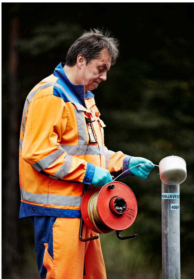
Pohjaveden mittausta Harjavallan Suurteollisuuspuistossa. Kuva: Boliden Harjavalta.
