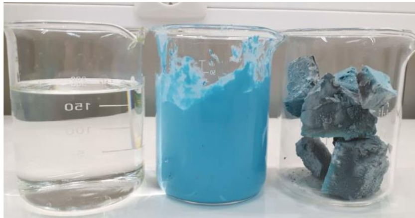
Kuva 6. Käsittelyn jälkeen kontista otettu vesi vasemmanpuoleisessa astiassa ja turkoosi märkä sakka keskimmaisessä. Kuivattu sakka on kiinteä, kuten oikeanpuoleisessa lasissa. (kuva: EPSE Oy)
