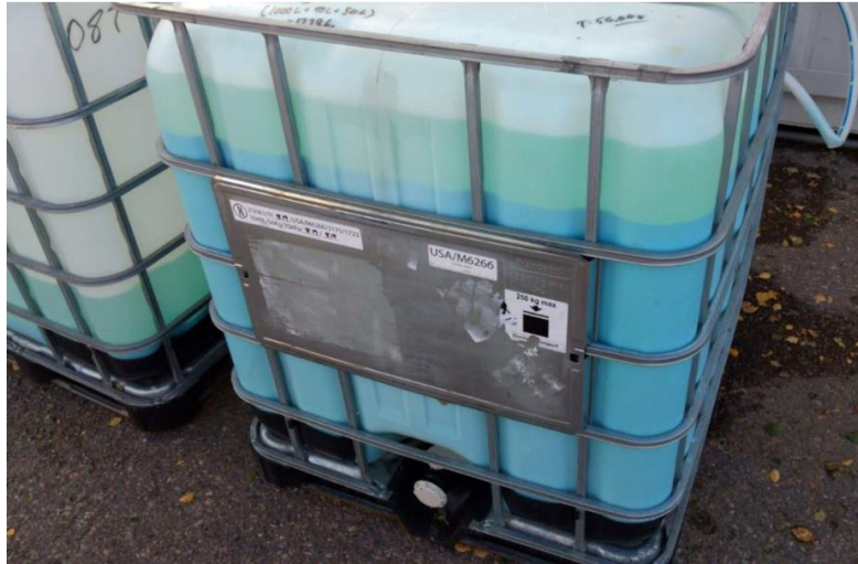
Kuva 4. Ensimmäisen eräkokeen tuotos IBC-kontissa. Turkoosi sakka on alkavut erottua vihertävältä näyttävästä vedestä. (kuva: EPSE Oy)
