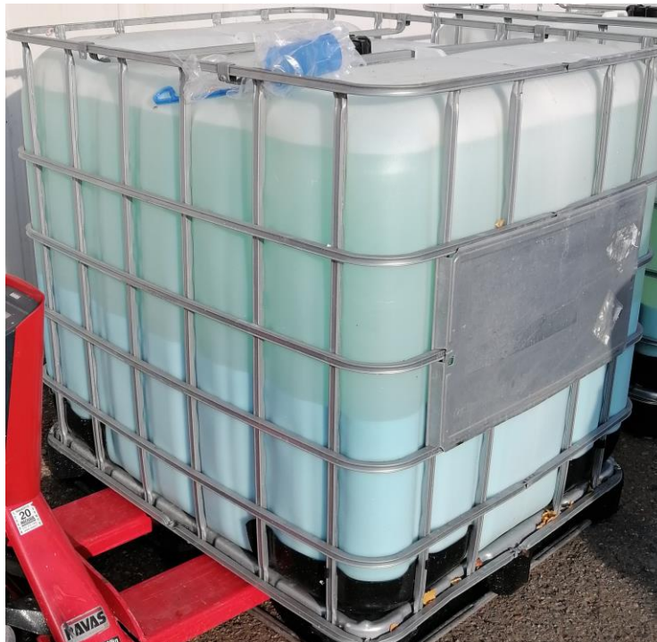
Kuva 5. Viikon kontissa ollut lopputuote. Sakka on tiivistynyt kontin pohjalle. (kuva: Prizztech Oy)
