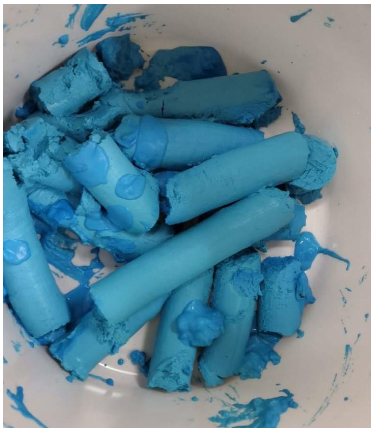
Kuva 7. Useita viikkoja kontissa ollut sakka oli tiivistynyt niin paljon, että jäi ulosvalutettaessa pötkömäiseen muotoon. (kuva: EPSE Oy)
