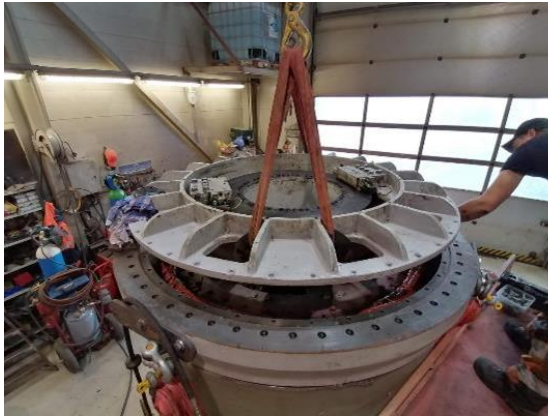
Kuva 12. Generaattorin takakannen irrotus ja nosto
