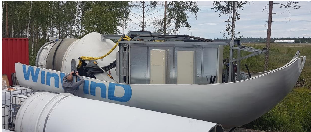
Kuva 4. Konehuone ilman kattoa.
