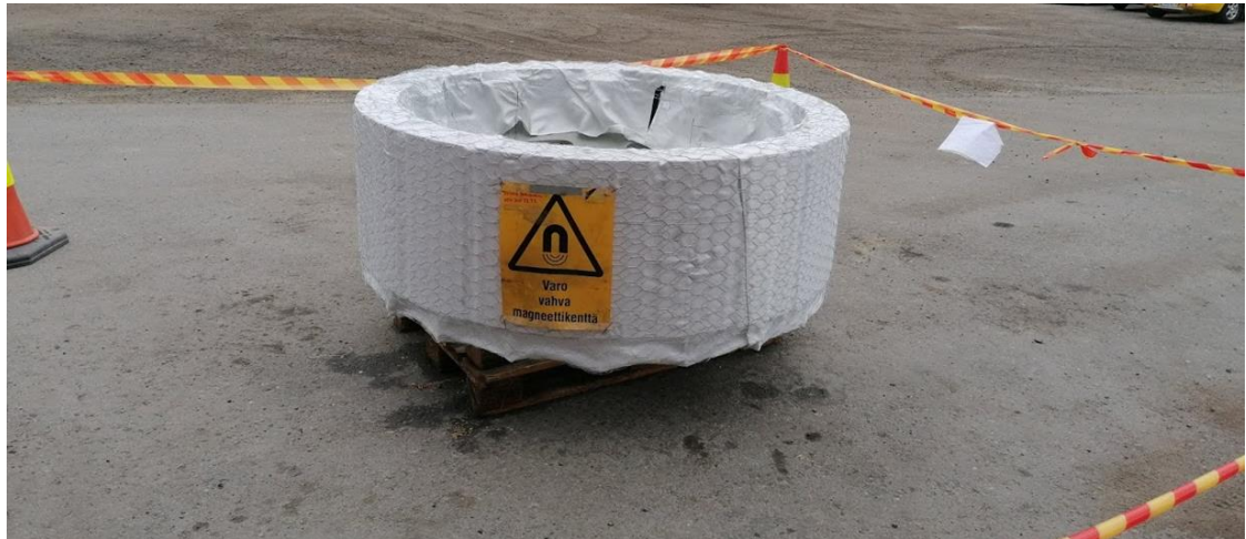
Kuva 17. Roottori valmisteltiin lämpökäsittelyyn huputtamalla se sammutuspeitteeseen
