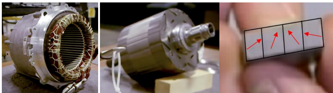
Kuva 2.2-2 Tesla Model 3:n kestopagneettimoottorin staattori, roottori ja hahmotelma Halbach-magneetista [41]
